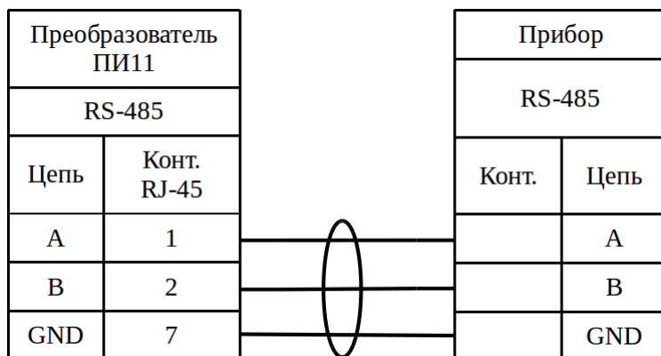
Рисунок 3 — Подключение приборов по интерфейсу RS-485
